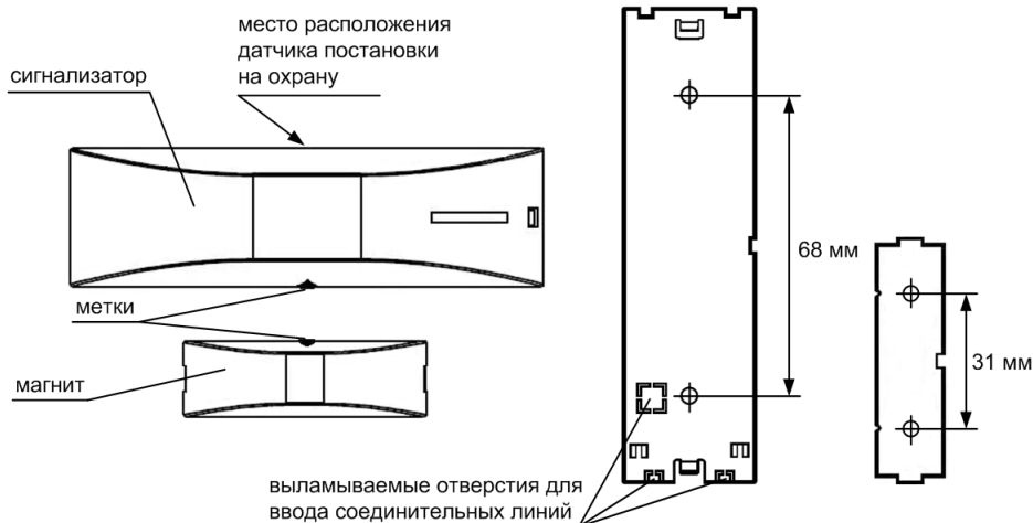
Рис.9 Схема установки, присоединительные размеры
