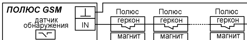
Рис. 6б Схема подключения внешних датчиков. Значение «1» параметра №37
