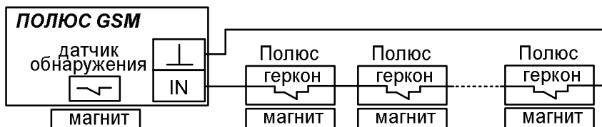
Рис.6а Схема подключения внешних датчиков. Значение «2» параметра №37
