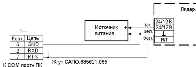
Рисунок 5 – Схема подключения блока приемника «Лидер 4» к СОМ порту персонального компьютера (ПК). Жгут подключения поставляется отдельно.
